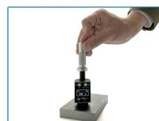
3. Нажмите на кнопку для проведения измерения. Значение твердости отобразится на экране
