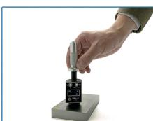
1. Установите твердомер в точке измерения
