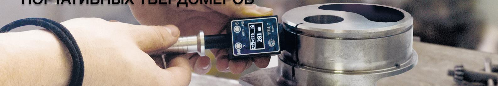
Портативные твердомеры ТПЦ предназначены для неразрушающего измерения твердости изделий из углеродистых конструкционных сталей по шкалам Бринелля, Роквелла и Виккерса. Твердомеры также позволяют оценивать твердость других металлических материалов: легированных сталей, чугунов, цветных металлов и сплавов.
