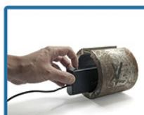
Контроль твердости в труднодоступных местах прибором ТПЦ-4М
