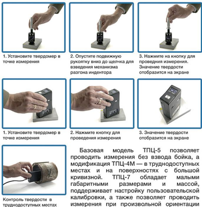
1. Установите твердомер в точке измерения
