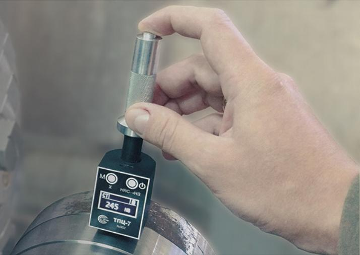
Портативные твердомеры ТПЦ предназначены для неразрушающего измерения твердости изделий из углеродистых конструкционных сталей по шкалам Бринелля, Роквелла и Виккерса. Твердомеры также позволяют оценивать твердость других металлических материалов: легированных сталей, чугунов, цветных металлов и сплавов.
