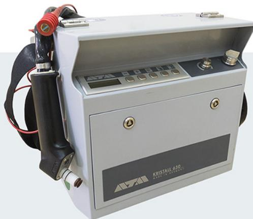
Для построения графиков изменения напряжений по глубине имеется специальная установка для электрохимического травления материала.
