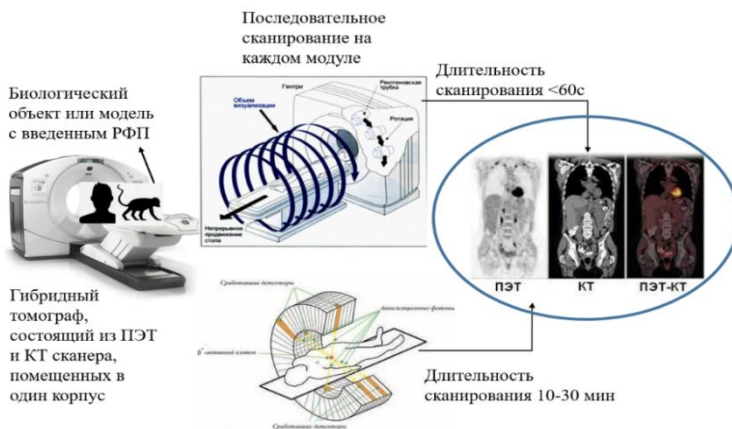
Рисунок 1 – Схема технологического процесса ПЭТ/КТ диагностики, включающая основные этапы получения диагностического изображения биологического объекта
